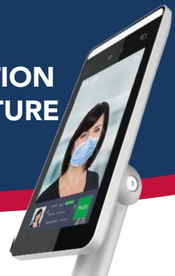
**Fonction principale :** Ce dispositif permet la mise en place d'un contrôle de la température par passage individuel ainsi que la détection de port de masque, le tout associé à la reconnaissance faciale de la personne.
